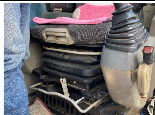
รูปที่ 27 ติดตั้งวัสดุป้องกันการสั่นสะเทือน
