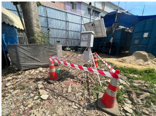
รูปที่ 67 ติดตั้งเครื่องตรวจวัดคุณภาพสิ่งแวดล้อม (คุณภาพอากาศ ระดับเสียง เสียงรบกวน และความสั่นสะเทือน)
